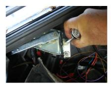
15. ユニットの線を結束バンドで固定し、茶をゴムブッシュより車内に挿入してアクセサリー電源等(ラジオ等から供給可能)に接続します。エンジン回転数連動機能を使用(有効)の場合は紫をエンジン側へ結束バンドで固定していきます。エンジン回転数連動機能を未使用(無効)の場合は紫の配線は不要です。⑫に説明がありますように桃色と接続しておいて頂いて⑩へ進んでください。
