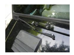
2. モーター軸の止めネジ(プラスチック)の取り外し スパナ・モンキー・ボックスレンチ等でプラスチックのナットを外します。 この時、モンキー、スパナ等ではボディーにあたりますので傷をつけない ように注意します。
