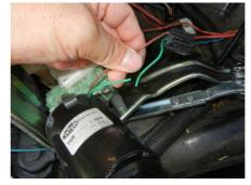
7. モーター側にユニットの白を接続します。エレクトロタップはしっかりと 両サイドのストッパーが確実に止まるようにプライヤ等で接続します。
