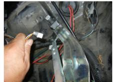
6. モーターのコネクターを外して緑の線を切断します。
