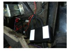
20. このあとボンネットを閉めてイグニッションをオンして実際の動作を確認してください。まずエンジンを2000rpm程度に回した状態で間欠動作にして、2秒程度(イグニッションオン直後の場合)の間欠で動作する事。エンジンをアイドリング状態800rpm程度にして間欠動作が先の2倍程度になることを確認してください。アイドリング状態で停止状態を認識しない場合はアイドリングが高い可能性がありますので調整が必要です(出荷時の閾値は1000rpm程度に設定してあります)。次に連続動作で低速・高速を切替てうまく動作するかどうかです。出荷時はビデオにあるような速度にしていますが、遅すぎてトルク不足でうまく動かない場合(ワイパーを回すのにモーター負荷が大きい場合等)は調整が必要です。
