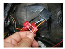
12. エンジン回転数連動機能を有効にするためユニットの赤(ヒューズ部分の ユニット側にユニットの桃を接続します。この機能を無効にするにはユニットの赤には何も接続せず、桃(有効・無効選択)と紫(エンジンパルス線)をエレクトロタップで接続しておきます。右写真は接続完了後の写真です。なお無効時の接続写真は割合させていただいていますが、赤に桃接続がなくて桃と紫(長さを適当に切ってください)をつなぎます。
