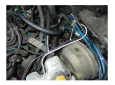
16. エンジンの回転数信号を取り出します。フロント側のイグニッションコイルユニットのコネクターを外します。写真では(私の車)既に白線にタコメータの線が接続されていますが、本来この接続はありません。
